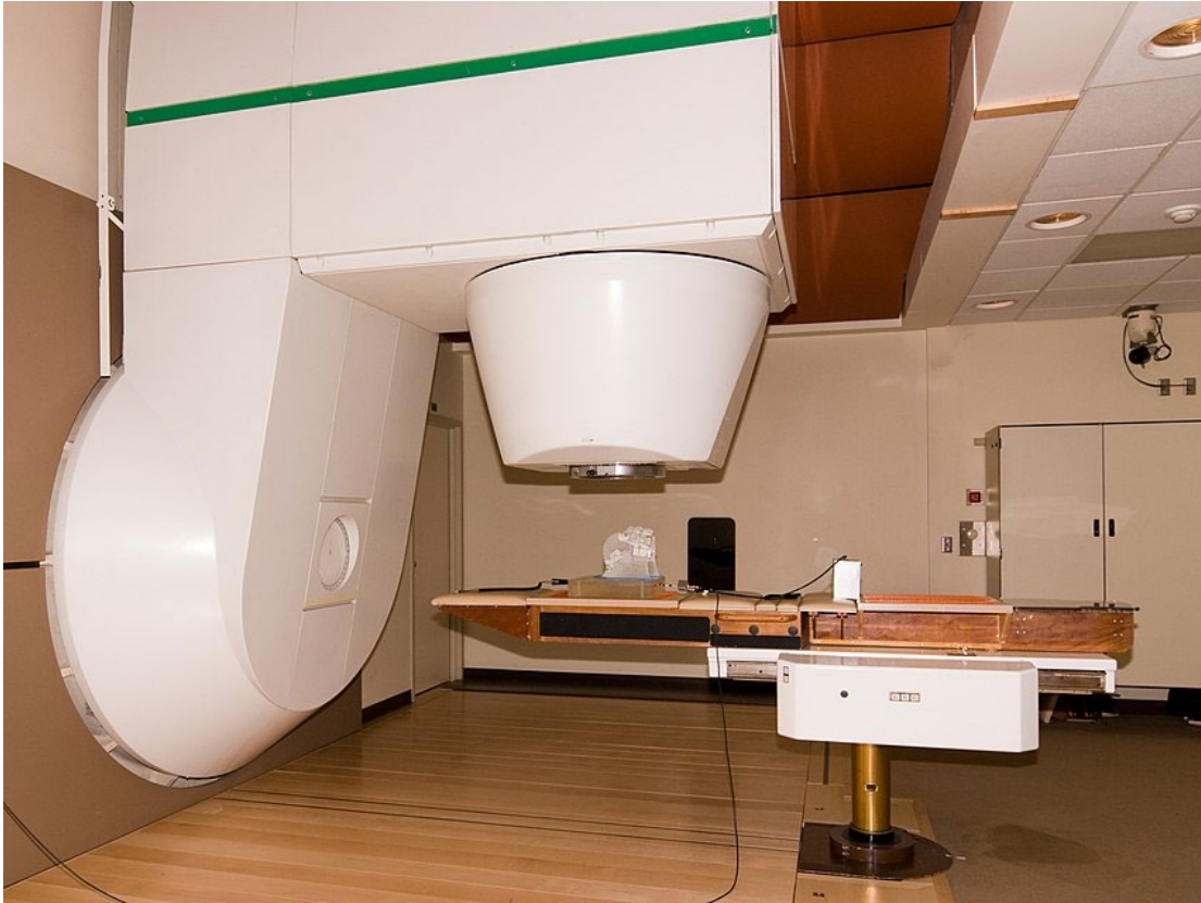
Fig. 11. Cabezal del ciclotrón generador de neutrones rápidos para uso clínico de la Universidad Washington de Seattle (USA). Instalado en 1983 ha funcionado durante 30 años. Fue fabricado por Scanditronix. (MC 50).
