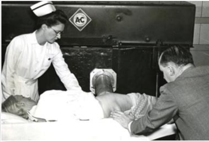
Fig. 6. Uno de los primeros betatrones fabricados por Allis Chalmers de Milwaukee para uso médico en radioterapia. El haz de radiación es horizontal debido a la nula movilidad del cabezal, por lo que es el paciente el que debe adaptarse al mismo mediante su giro y la movilidad vertical y longitudinal de la mesa de tratamiento.
