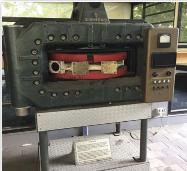
Fig. 5. Betatron de 35MV fabricado por Siemens para estudios de física, expuesto en la Universidad de Melbourne.
