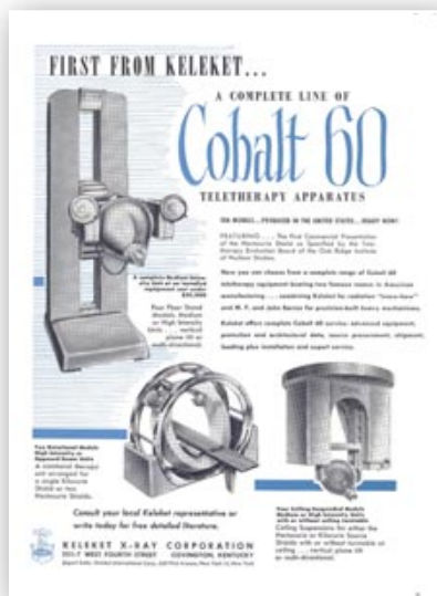
Fig.11. Gama de modelos del fabricante estadounidense Keleket. El primer aparato montado en un estativo de columna tenía movimiento bastante limitado, al igual que el que aparece en el ángulo inferior derecho. Simétrico a él, un modelo giratorio dispuesto en arco, similar a los TACs actuales. Esta disposición la adoptó posteriormente la casa inglesa MEL en sus aceleradores y la han mantenido sus sucesores (Philips y actualmente Elekta).
