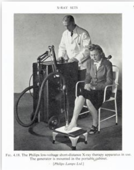
Fig. 4. El popular generador de RX superficial Philips de 50Kv aparece en la foto en una aplicación de radioterapia cutánea. Probablemente es una imagen publicitaria de simulación ya que es muy poco habitual la localización de un carcinoma cutáneo u otra lesión benigna en el dorso de los metatarsianos del pie. ( Philips Lamps Ltd. ).
