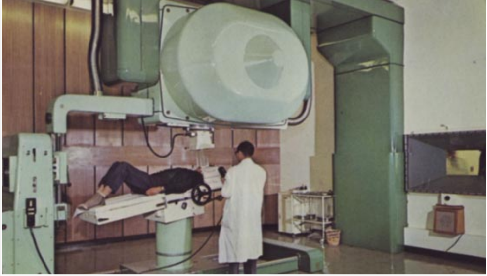
Fig. 10. Betatron de 35 MV fabricado por la firma suiza Brown-Boweri, denominado Asklepitrón. Al estar montado el cabezal sobre un eje horizontal, se permitía un giro angular limitado para haces de radiación oblicuos. Este aparato estuvo instalado en el Queen's Elisabeth Hospital de Hong Kong. (Imagen de Física Médica de dicho hospital).
