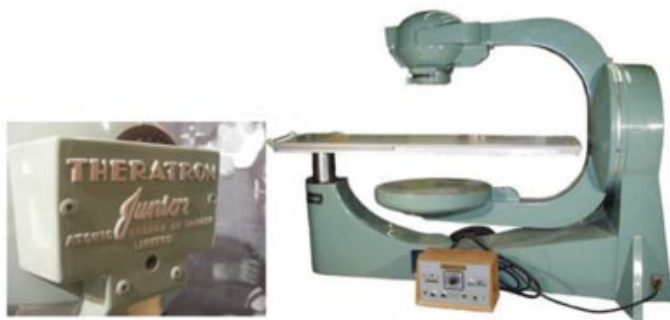
Fig. 8. Imágenes del Theratron Junior que se exhibe en el Museo de Ciencia y Tecnología de Canadá. El cuadro de mandos se halla situado al pie del soporte de la mesa de tratamiento. Es la unidad nº 15 de las 140 que se fabricaron y había estado operativa en el Our Lady of Lourdes Hospital.
