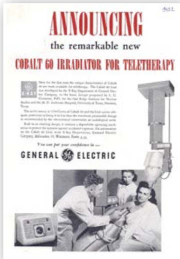
Fig. 2. Anuncio de la primera bomba de Cobalto fabricada por General Electric en USA en 1951. El cabezal conteniendo la fuente está montada en un brazo telescópico articulado.
