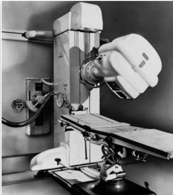
Fig. 9. En esta imagen se muestra una versión más antigua del betatron Siemens de 18MV. Era un aparato de menor energía y coste que el de 42 MV. Tenía el problema de su menor movilidad al no ser isocéntrico y estar montado el cabezal sobre un estativo de columna. En Barcelona se instalaron dos, en el Hospital de la Esperanza y en la Clínica Quirón.
