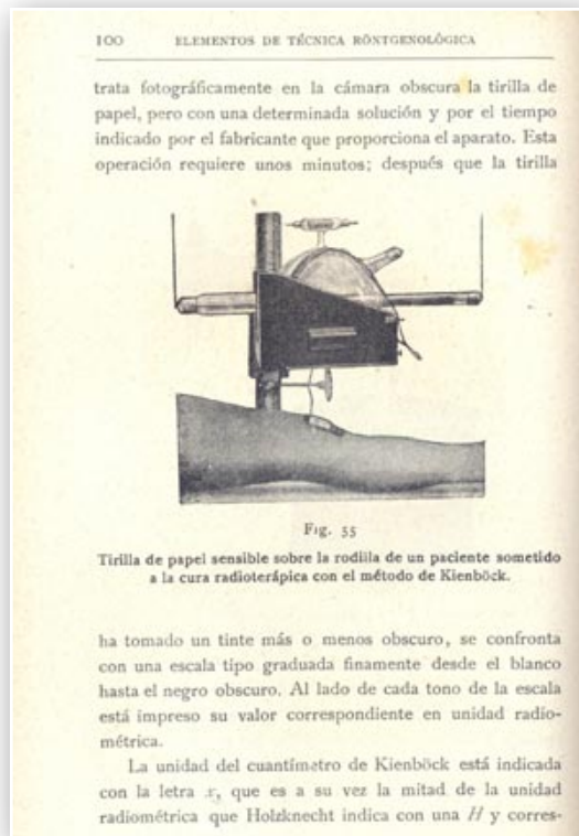
Fig. 5. Aparato de radioterapia con dosimetría mediante tira impregnada con la sal BrAg que se ennegrece proporcionalmente a los RX absorbidos. La tira va envuelta en un doble sobre hermético negro y una vez revelada, la dosis se determina en la escala del cuantímetro de Kienböck (Pág 100).
