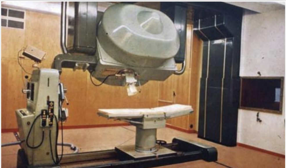
Fig. 11. Otra imagen del betatron de Brown Boveri de 35MV denominado Asklepitrón. Su peso era de 11 toneladas. La pared del fondo, al igual que en el de la imagen anterior, se forró de madera para favorecer la absorción de los neutrones secundarios producidos en estas altas energías.
