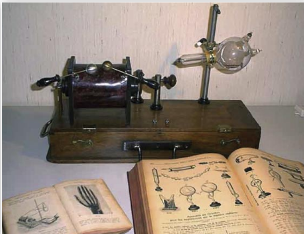
Fig. 2. Imágenes de un carrete de Rumhork (izq.) generador de alta tensión y un tubo de Crookes en el que se aceleran los electrones. En las páginas abiertas de los libros pueden verse imágenes radiográficas y diversos modelos de ampollas.
