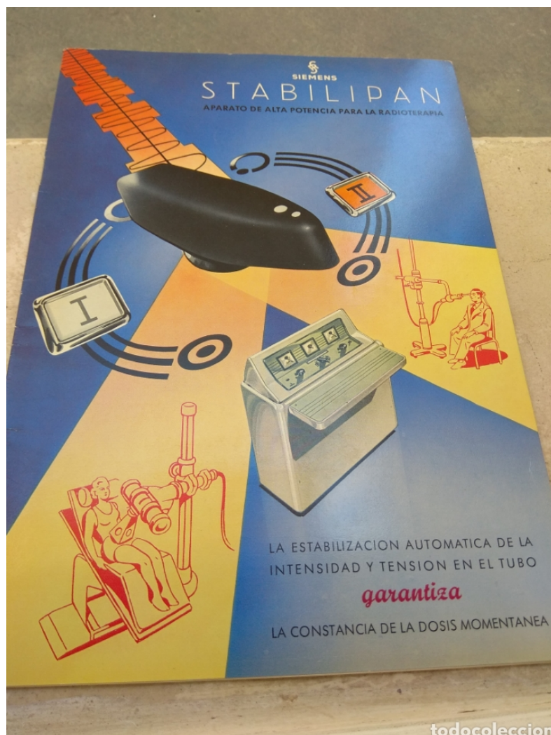
Fig. 7. En esta portada de otro folleto informativo, también editado en castellano, se hace énfasis en que la misma consola de mando puede regular el funcionamiento de dos generadores simultáneamente, en este caso un Stabilipan y un Chaoul de contacto. El protagonista de la imagen es el botón selector, en tamaño gigante, que permite irradiar con uno u otro generador. Recalcan de nuevo el sistema estabilizador de tensión e intensidad que incorporan y que garantiza la estabilidad de la tasa de dosis. Este hecho es fundamental al programarse tiempo de irradiación y no dosis.
