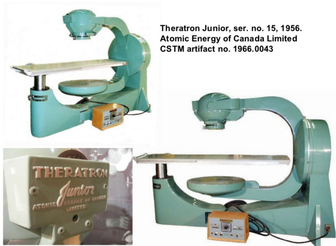
Fig. 7. Imágenes del Theratron Junior que se exhibe en el Museo de Ciencia y Tecnología de Canada. El cuadro de mandos se halla situado al pie del soporte de la mesa de tratamiento. Es la unidad nº 15 de las 140 que se fabricaron y había estado operativa en el Our Lady of Lourdes Hospital
