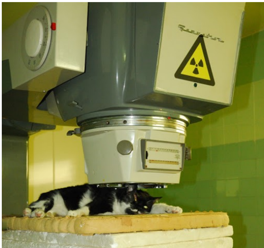
Fig. 13. Gammatron III instalado en Budapest para irradiación de animales de experimentación (un gato?)
