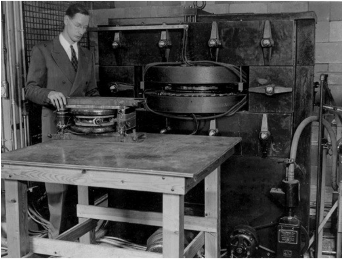
Fig. 3. El Pr. Donald Kerst muestra el primer betatron, de pequeño tamaño, construido por él en 1940 en el laboratorio de la Universidad de Illinois. A su lado izquierdo se muestra un betatron más potente construido bajo su dirección por la firma Allis Chalmers Company, de Illinois (USA). Este primer betatron tenía como finalidad el análisis de defectos ocultos o grietas en metales dedicados a armamento para la guerra mundial.
