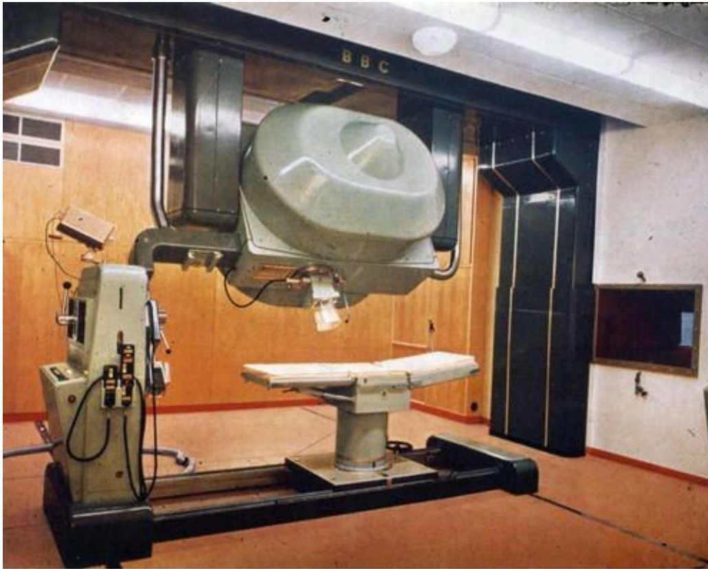
Fig. 11. Otra imagen del betatron de Brown Boveri de 35MV denominado Asklepitron. Su peso era de 11 toneladas. La pared del fondo, al igual que en el de la imagen anterior, se forró de madera para favorecer la absorción de los neutrones secundarios producidos en estas altas energías.
