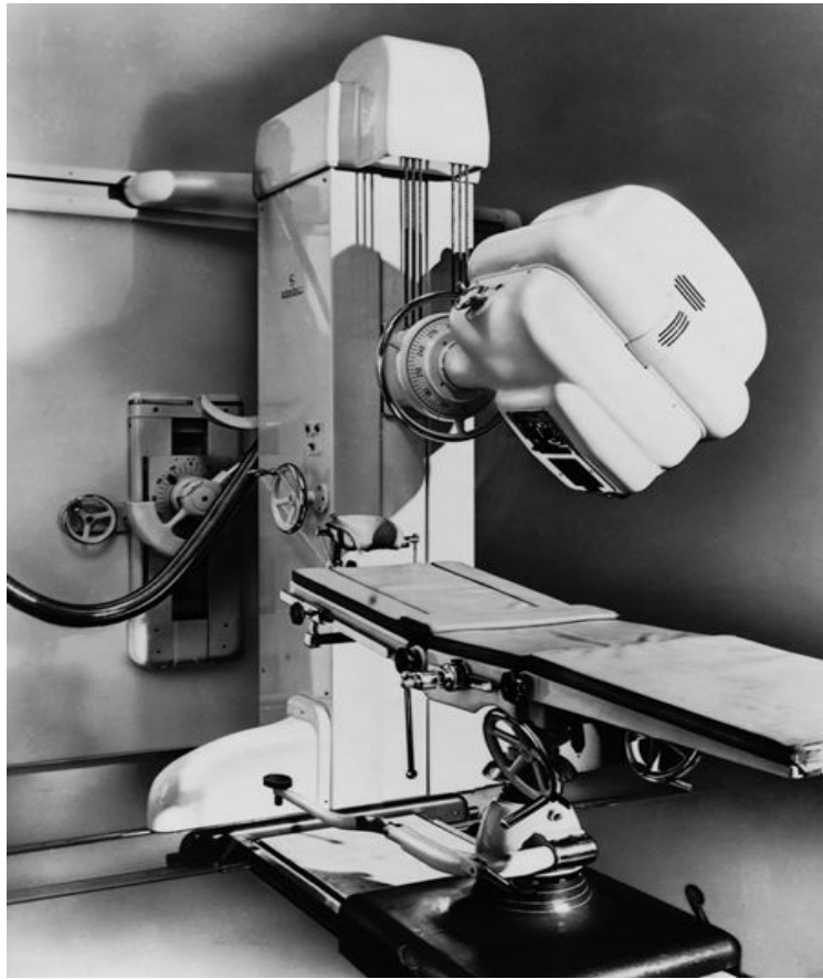
Fig. 9 . En esta imagen se muestra una versión más antigua del betatron Siemens de 18MV. Era un aparato de menor energía y coste que el de 42 MV. Tenía el problema de su menor movilidad al no ser isocéntrico y estar montado el cabezal sobre un estativo de columna. En Barcelona se instalaron dos, en el Hospital de la Esperanza y en la Clínica Quiron.
