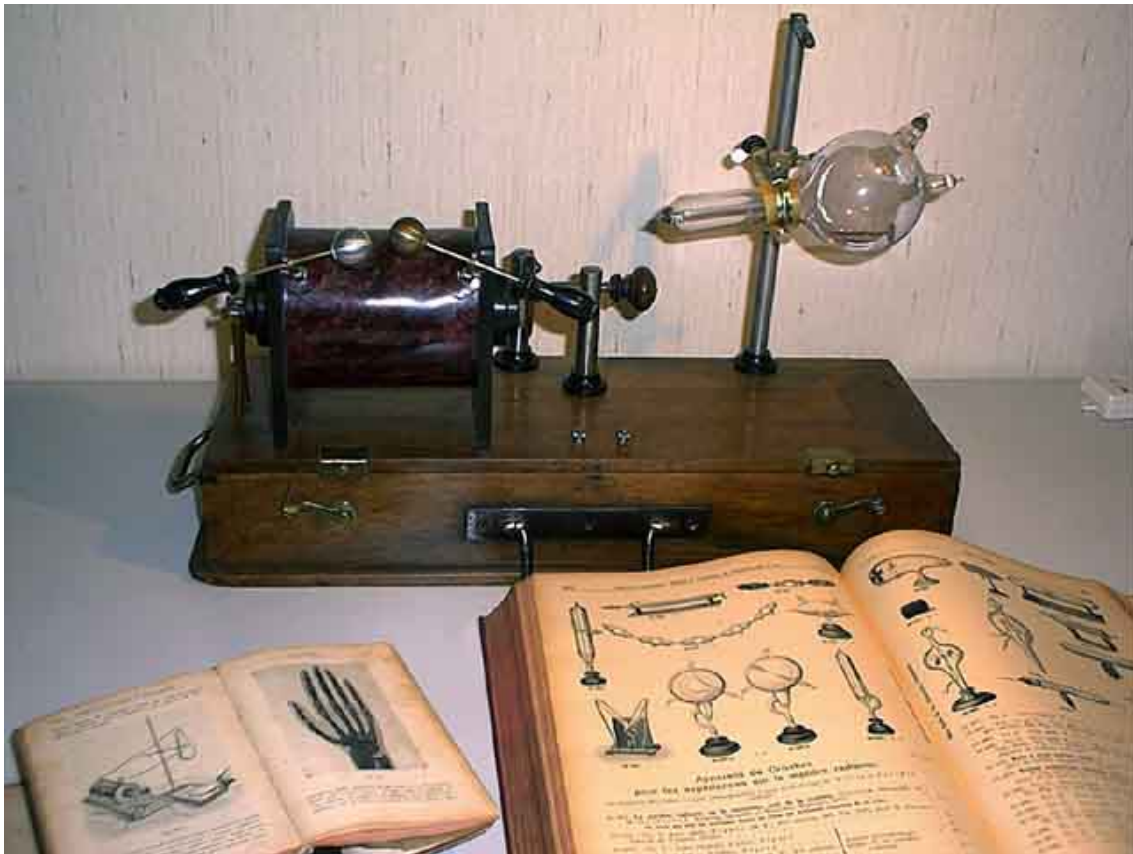
Fig. 2. Imágenes de un carrete de Rumhkorf (izq.) generador de alta tensión y un tubo de Crookes en el que se aceleran los electrones. En las páginas abiertas de los libros pueden verse imágenes radiográficas y diversos modelos de ampollas.
