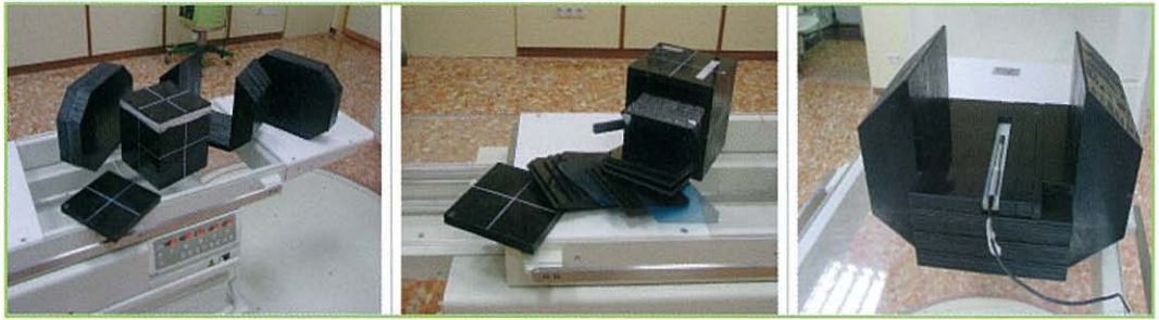
Figura 20- Maniquí de verificación para IMRT. Nos permite alojar películas en diferentes posiciones para dosimetría relativa y una cámara de ionización también en diferentes sitios para dosimetría absoluta.
